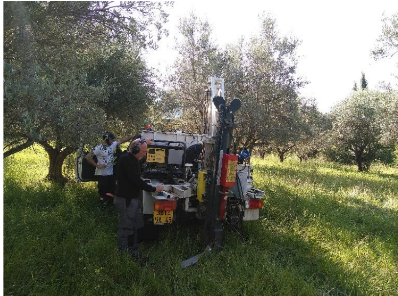
À gauche : photos d'un récepteur sans fil utilisé pour l'imagerie sismique 3-D (haut) et d'un géophone relié au câble de mesure (bas, profil 2-d sismique réfraction). À droite : Photo de la source sismique de type chute de poids accélérée A200P.
